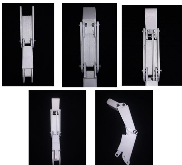
Figura 10. Proceso de montaje de los dedos mediante las piezas fabricadas en la impresora 3D
