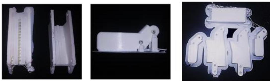
Figura 9. Imagen de las falanges una vez fabricadas con la impresora 3D
