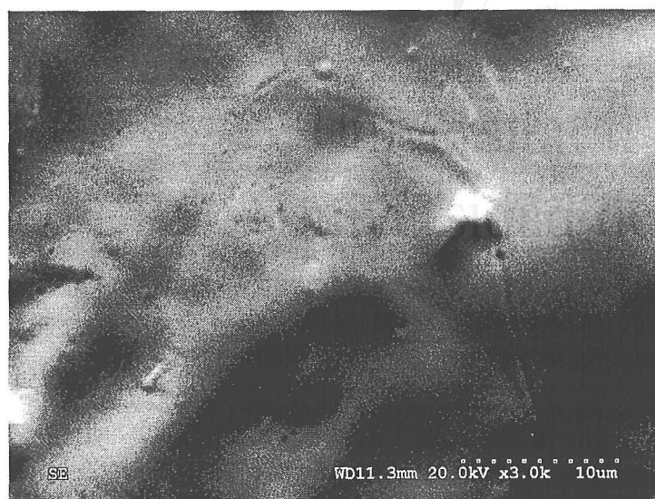
Figura 4.16-b) Micrografía electrónica de barrido de la superficie del electrodo de oro recubierto por la película polimérica generada por oxidación electroquímica del 3-ABA 0.01M durante 25 ciclos hasta el potencial límite 1.25 V (3000 aumentos).
