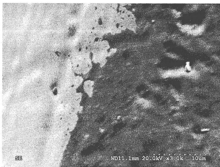
Figura 3.18-c), Micrografía electrónica de barrido de la superficie del electrodo de platino recubierto por la película polimérica generada por oxidación electroquímica del 4-ABA 0.01M durante 25 ciclos hasta el potencial límite de 1.25 V (3000 aumentos). La parte izquierda de la fotografía muestra el platino limpio y la derecha el Poli(4-ABA)
