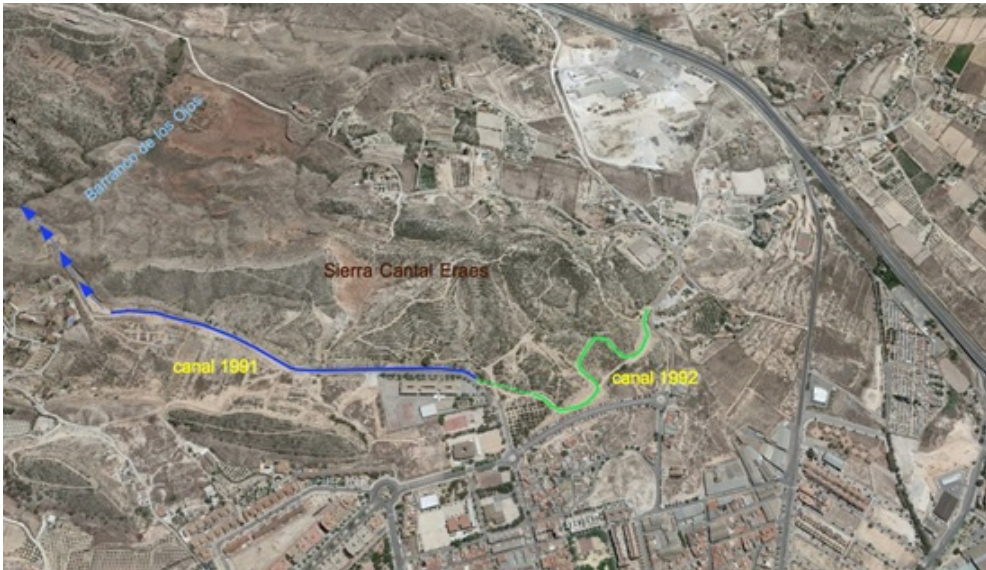
Figura 6. Trazado y fases constructivas del canal de avenamiento.
