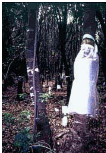
Foto 6. Aspecto que presenta un árbol preparado para medir el flujo de savia. El punto de medida se debe de cubrir para su protección y para mantener mínimas oscilaciones de temperatura en sus proximidades. También se pueden observar colectores de agua para la medida de la precipitación penetrante.
