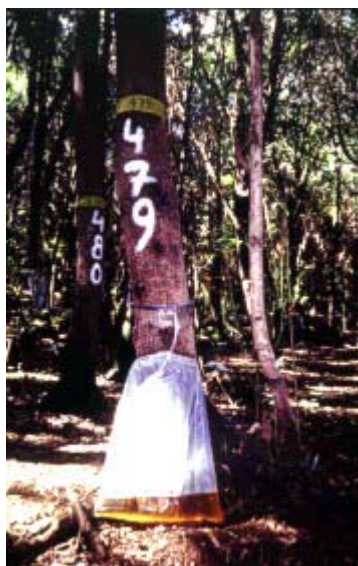
Foto 7. Medida del escurrido cortical. El agua que escurre por la corteza es recogida en la bolsa de plástico que posteriormente se cuantifica.
