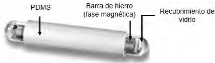
Figura 4.19 Barra agitadora magnética utilizada en la técnica de extracción por sorción en barra agitadora [Fuente: adaptada de la referencia 38].
