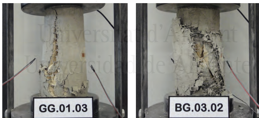
Figura 5.15. Detalle de la rotura de las muestras formadas por 3 piezas con juntas de mortero reforzadas con FRCM (mallas de fibras de vidrio o carbono).
