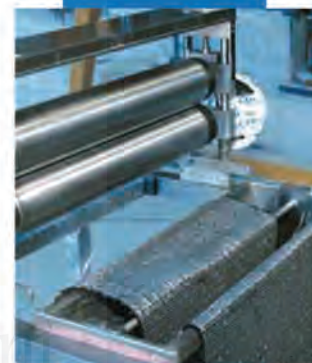
Impregnación a máquina de MapeWrap C
