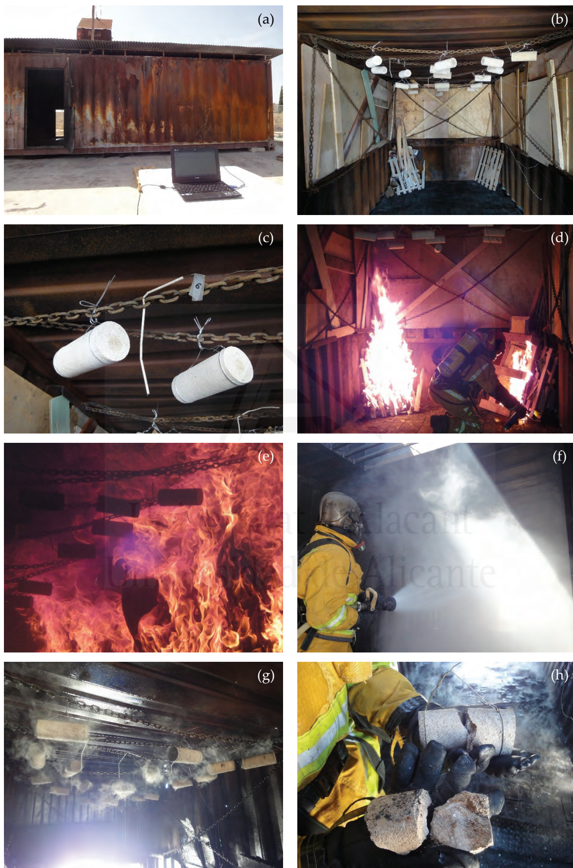
Figura 4.17. Proceso de exposición de las muestras de piedra a la acción de fuego real.
