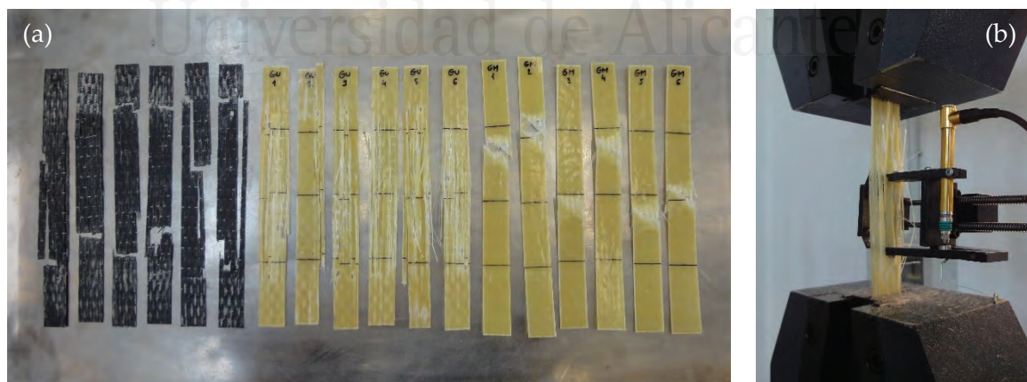
Figura 4.7. Laminados ensayados a tracción (a) y detalle de los equipos empleados para el ensayo (b).
