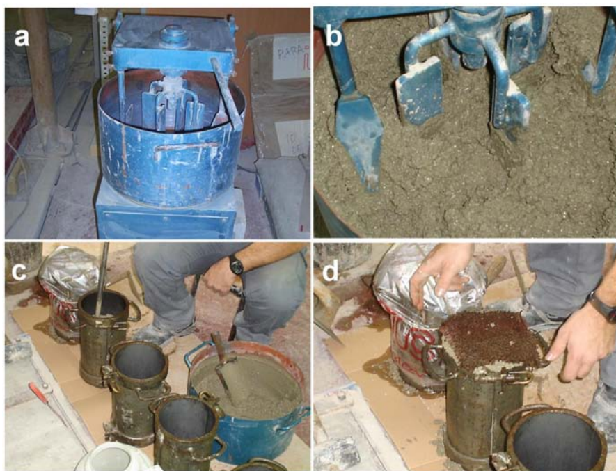
Figura 3.3 Proceso de amasado de las probetas a)-b) Fotografías de la amasadora usada en la fabricación de las probetas c) Imagen del picado con barra de la probeta durante el proceso de fabricación d) Fotografía de una probeta cubierta con una arpillera tras su elaboración.
