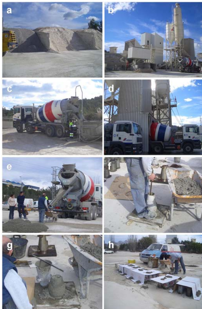
Figura 3.4: Proceso de fabricación y toma de muestras de la planta de la Nucía (Alicante)
