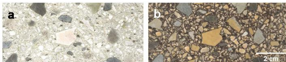
Figura 4.9: Aspecto de una probeta teñida con ácido tánico (8%) y ácido nítrico ( \text{pH} \approx 1 ) donde se puede observar cómo amarillean los áridos calizos.
