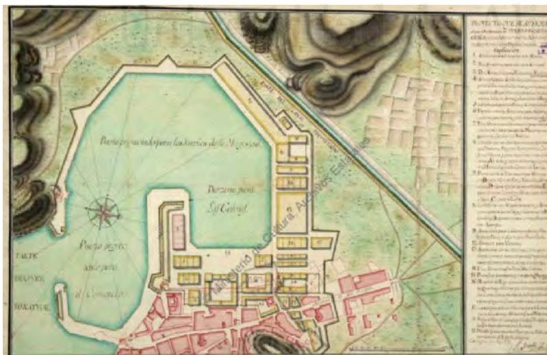
Fig. 16.3-8 "Proyecto que se aumenta al que se ha formado del puerto de Cartagena para establecer en él los edificios correspondientes a una marina completa". 1731. Alejandro Rez (AGS. MPD, 06, 093)
