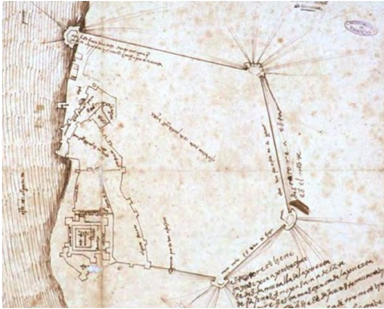
Fig. 13.3.1-1 Croquis del corregidor Andrés Dávalos sobre Cartagena y su puerto (1541), indicando las fortificaciones existentes y las proyectadas. Se aprecian dos recintos compartimentados y complementarios: la fortaleza, heredera de la alcazaba islámica, y la ciudad, producto de la retracción urbana de la madina. (A.G.S. M.P.D., XIX-167/169. Reproducido en VV.AA.: Catálogo de mapas, planos y dibujos del Reino de Murcia en el Archivo General de Simancas . Murcia, 2000, y VV.AA.: Estudio y catalogación de las defensas de Cartagena y su bahía . Murcia, 2002). (Munuera Navarro, 2010)
