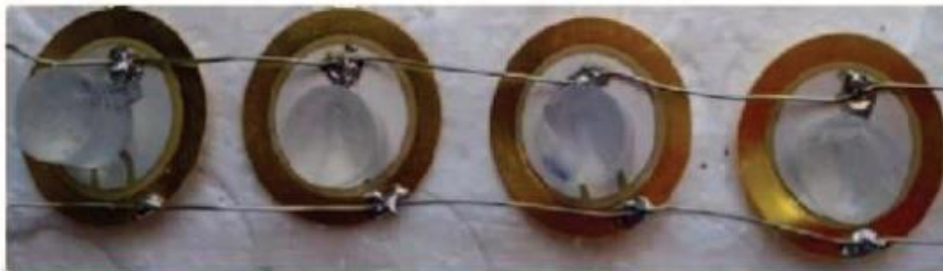
Figura 13 - Topes de gel de silicona colocados en los diferentes transductores piezoeléctricos
