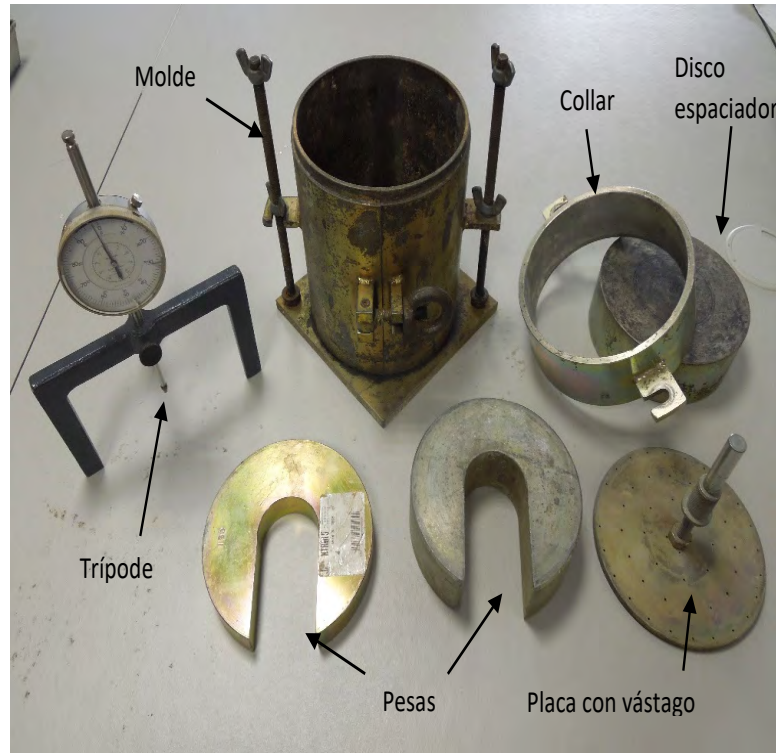
Figura 2. Parte del material necesario para la realización del ensayo CBR.
