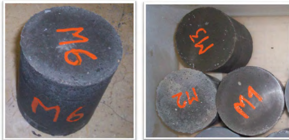
Figura 1. 12: Probetas de mortero una vez desmoldadas.
