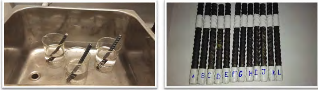
Figura 1. 13: Baño de aceros en ultrasonidos (izquierda) y posterior encintado (derecha).
