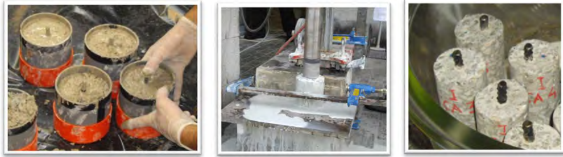
Figura 1. 15: Hormigonado de las probetas de 10cm de diámetro (izquierda), extracción de testigos (centro) y obtención de las probetas definitivas de diámetro 5 cm (derecha).
