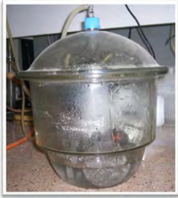
Figura 1. 28: Probetas siendo sometidas a la saturación a vacío.
