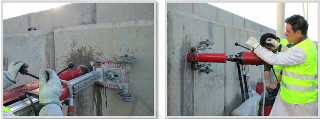
Figura 3. 17: Fotografías de una de las extracciones de los testigos de la tercera campaña en el muelle 17 del Puerto de Alicante.
