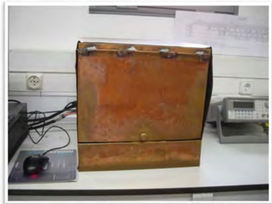
Figura 1. 36: Potenciostato y osciloscopio para la medida de Resistencia de Polarización Lineal. Figura 1. 37: Caja de Faraday de Cobre.
