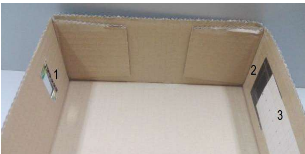
Interior del espectroscopio: 1) Agujero sobre el que se ha pegado la red de difracción. 2) Rectángulo de cartulina con la rendija. 3) Escala de papel milimetrado.
