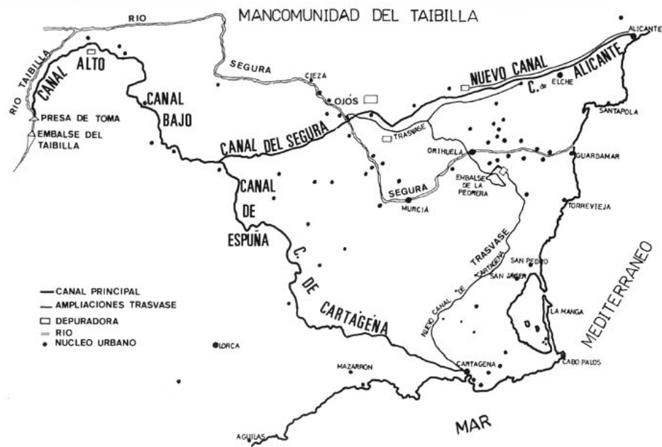
Red principal de los canales de distribución de aguas y localización de las depuradoras.
