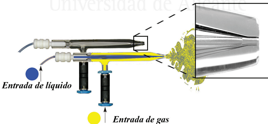
Figura 2.2: Esquema general de un nebulizador neumático concéntrico Conikal de la casa comercial Glass Expansion.
