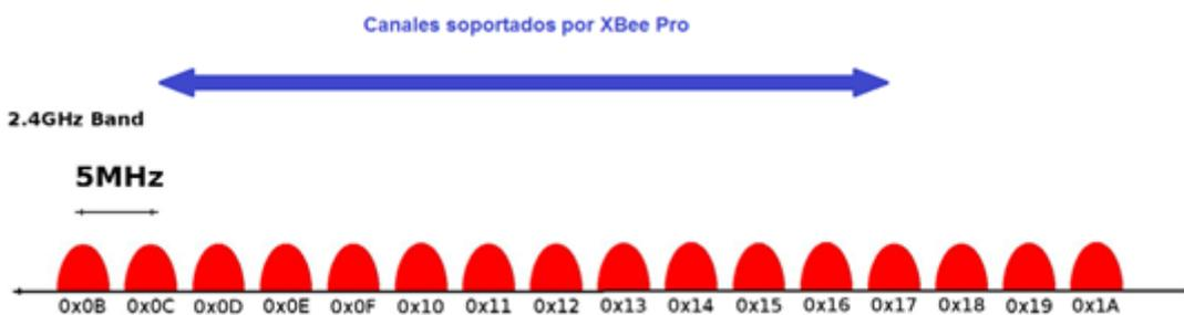
Fig. 21: Canales de frecuencias en la banda de 2,4 GHz
