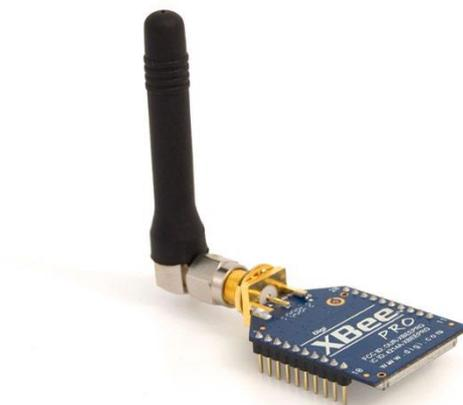
Fig. 20: XBee 802.15.4 PRO
