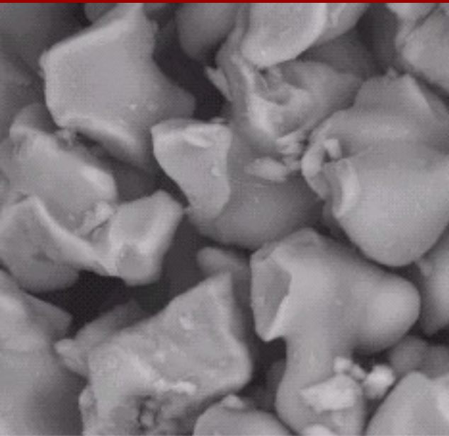
C/S hydratisiert, w/b-Wert=0.4, 4888x
