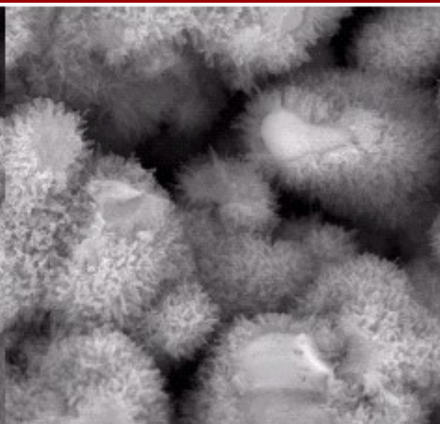
C/S hydratisiert, w/b-Wert=0.6, 4888x
