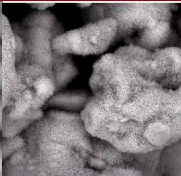
C/S hydratisiert, w/b-Wert=0.52, 4888x
