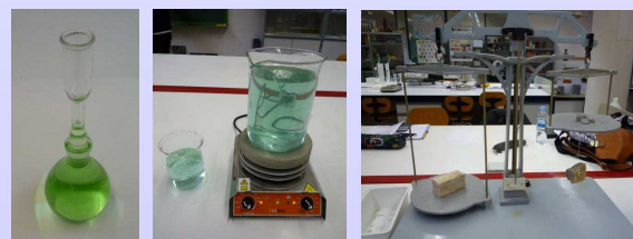
Figura 4. Material de la Práctica 3: picnómetro con líquido problema y balanza hidrostática para determinar densidades
