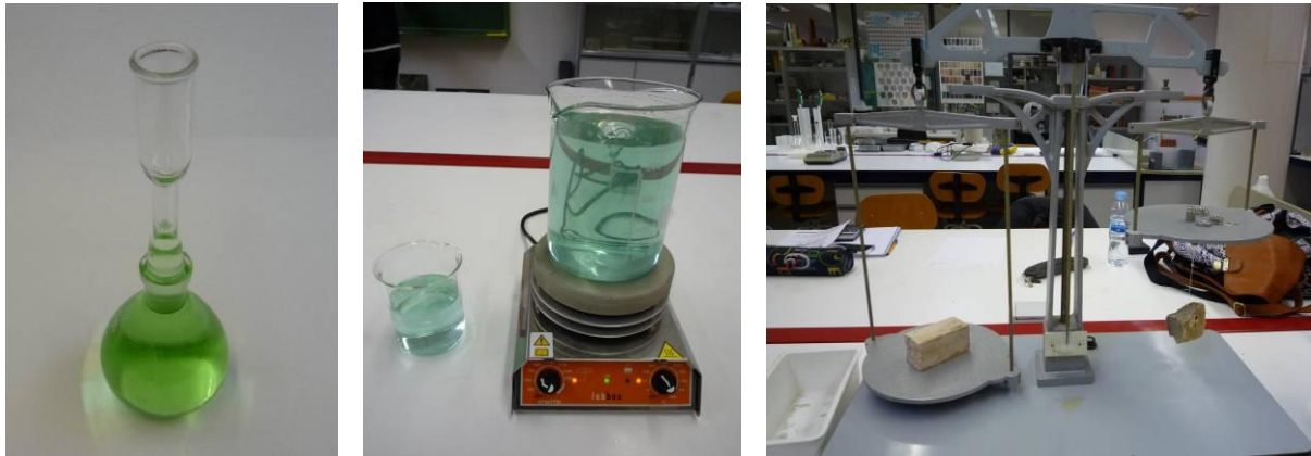
Figura 4.- Material e instrumental necesario para la Práctica 3 . (a) picnómetro lleno del líquido problema. (b) instrumental para la preparación del líquido problema. (c) balanza hidrostática para la determinación de la densidad del sólido problema.
