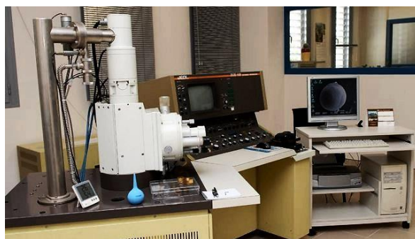
Figura 2.9. Microscopio electrónico de barrido marca JEOL modelo JSM-840.
