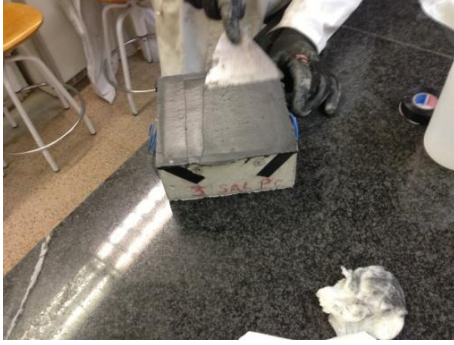
Aplicación de pasta grafito-cemento
