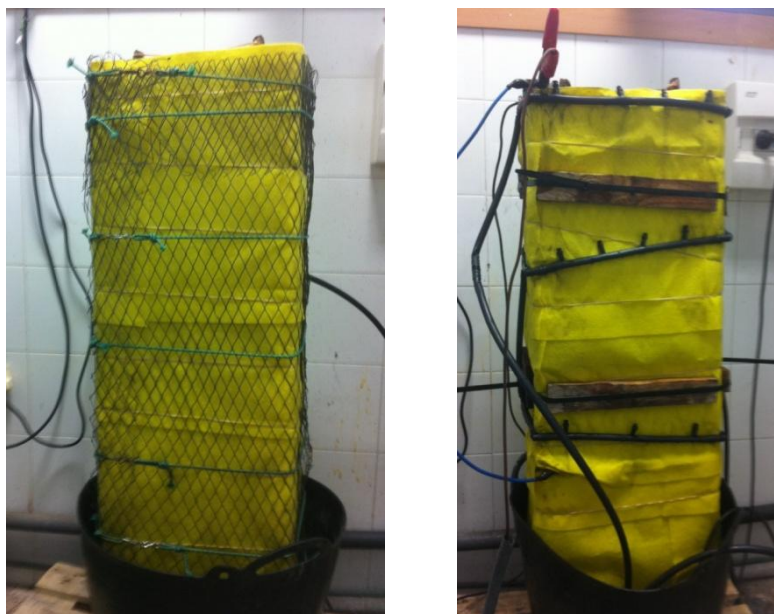
Fotografía 4.7. Montaje de espécimen tipo soporte de sección rectangular y sistema anódico con malla Ti-RuO 2 . Detalle de ajuste con bandas de madera (estudio 2.a.)
