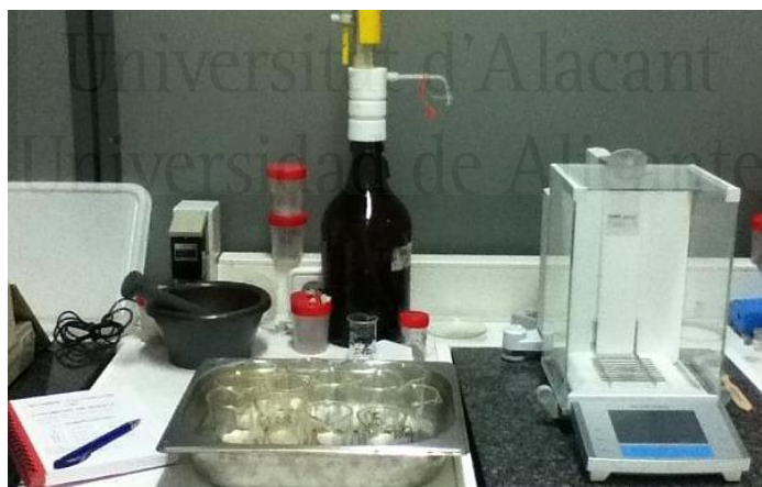
Fotografía 12.6. Balanza de precisión 0,0001 g y equipo
