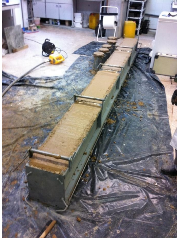
Fotografía 4.6. Hormigonado de probetas tipo soportes de sección rectangular 20 x 30 cm 2
