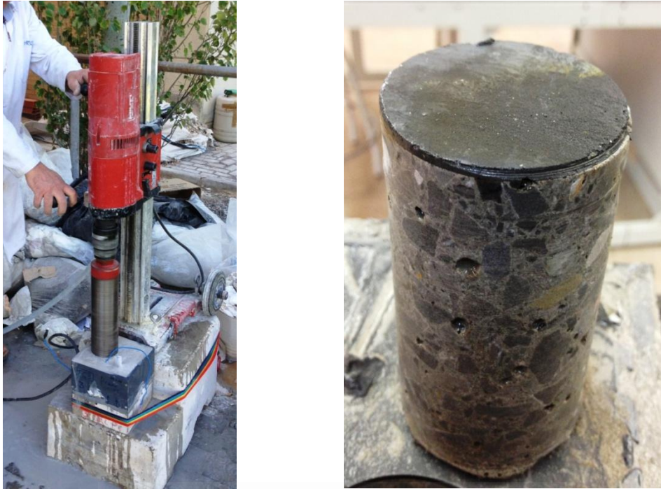
Fotografía 8.7. Extracción y testigo obtenido después de la EEC realizada a las probetas prismáticas tipo losa.
