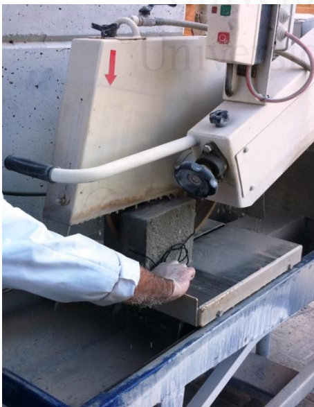
Operación de corte de probetas prismáticas
