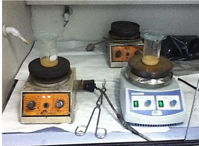
Fotografía 13.6. Calentamiento hasta ebullición con agitación de las muestras en los hornillos.
