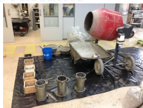
Operación de hormigonado
