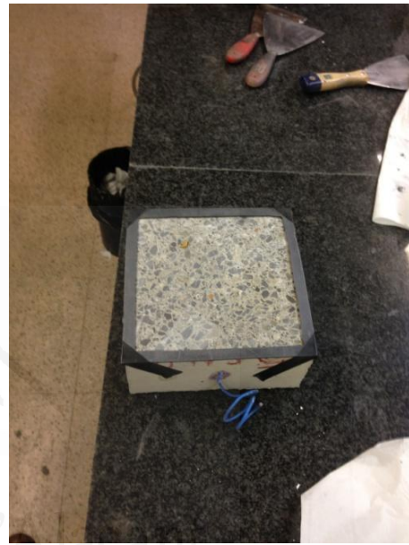
Bastidor para aplicación de capa de pasta grafito-cemento
