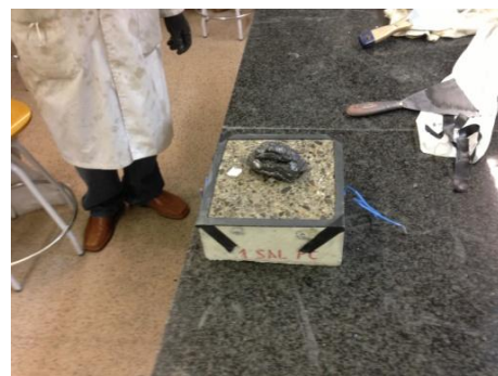
Pasta de grafito-cemento lista para ser aplicada
