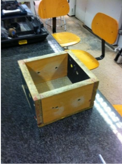
Detalle de encofrado de madera
