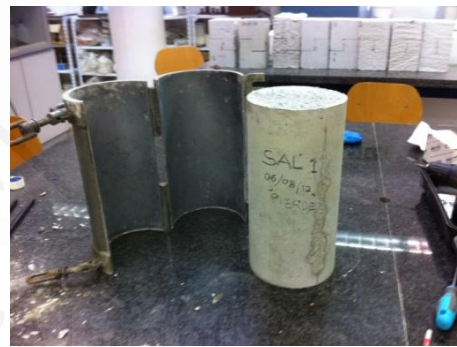
Desencofrado de probetas cilíndricas para ensayo de resistencia a compresión
