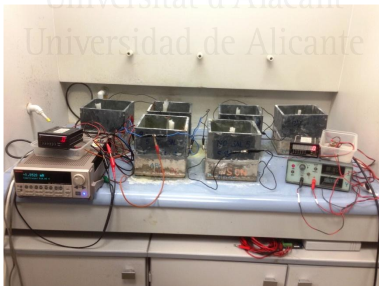
Fotografía 4.8. Montaje de las seis probetas que, después de las 25 semanas de tratamientos de PC ( 15 \text{ mA/m}^2 ) y PrevC ( 2 \text{ mA/m}^2 ) con contaminación simultánea, son sometidas de nuevo a PC con densidades superiores de corriente, ya sin contaminación.
