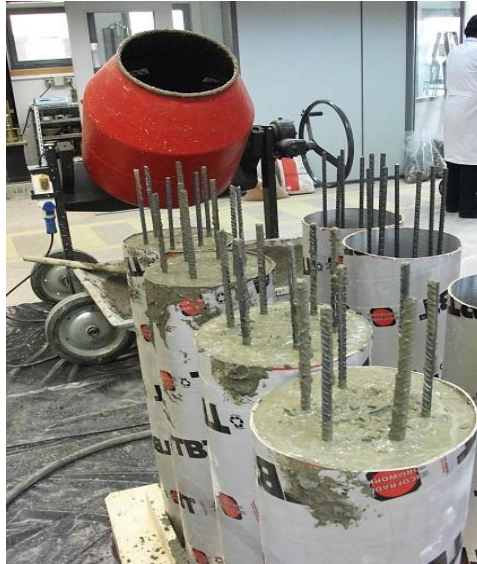
Fotografía 2.6. Hormigonera y encofrados después de vertido y vibrado
