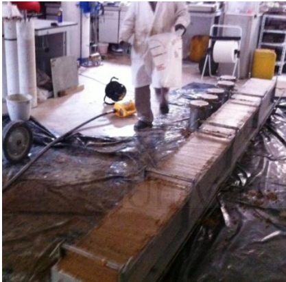
Fundido simultáneo de 4 especímenes tipo soporte de sección rectangular para EEC
