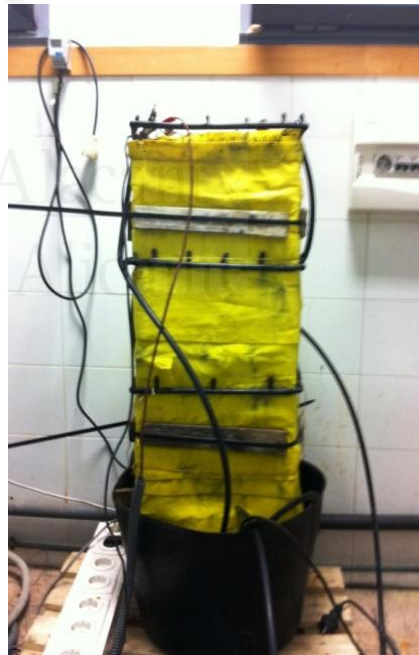
Montaje terminado espécimen con ánodo Ti-RuO_2
