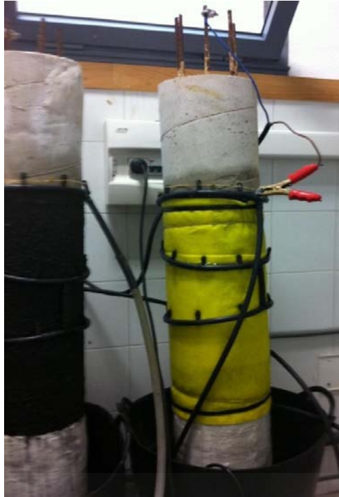
Fotografía 2.7. Detalle de montaje del espécimen con sistema anódico a base de pasta de grafito-cemento.
