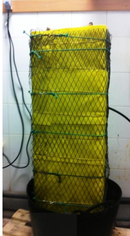
Montaje espécimen con ánodo Ti-RuO_2
