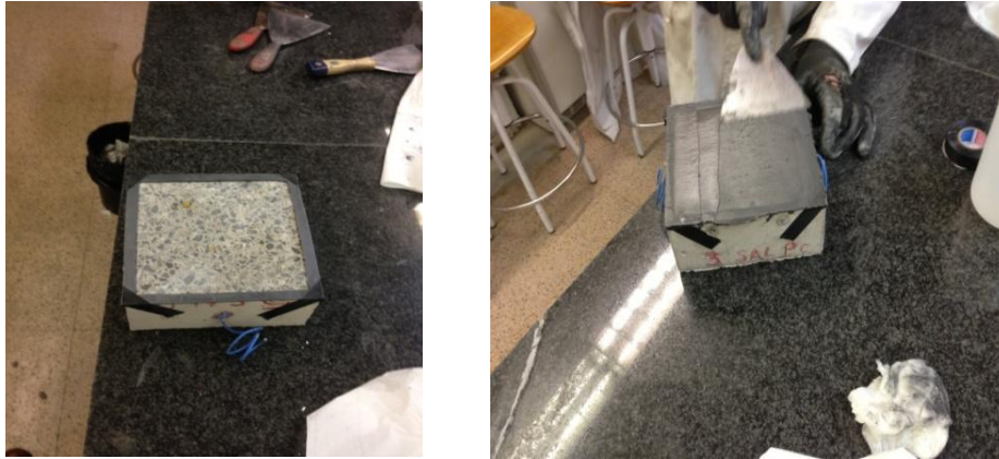
Fotografía 10.6. Extensión manual de capa anódica en las probetas prismáticas tipo losa.
