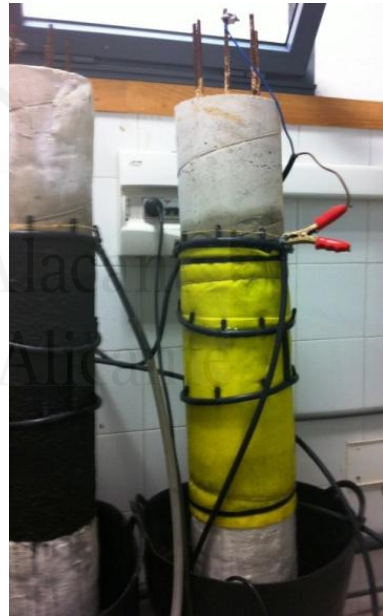
Especímenes tipo soporte de sección circular preparados para la EEC
