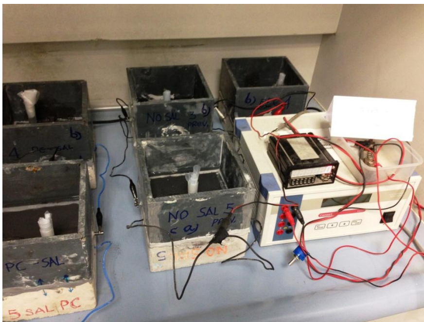
Fotografía 7.7. Conexión de juego de 3 probetas en serie con fuente eléctrica de corriente continua.
