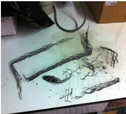
Banda de conexión Ti-RuO 2 afectada por acidificación anódica
