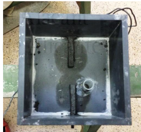
Fotografía 6.7. Detalle de elementos de conexión anódica, vaso y receptáculo para electrodo de referencia.
