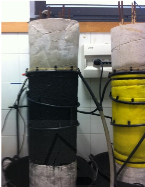
Fotografía 3.7. Montaje de espécimen tipo soporte de sección circular con riego periódico sin capas absorbentes estudio 1.d, junto a otro con protección (estudio 1.b).
