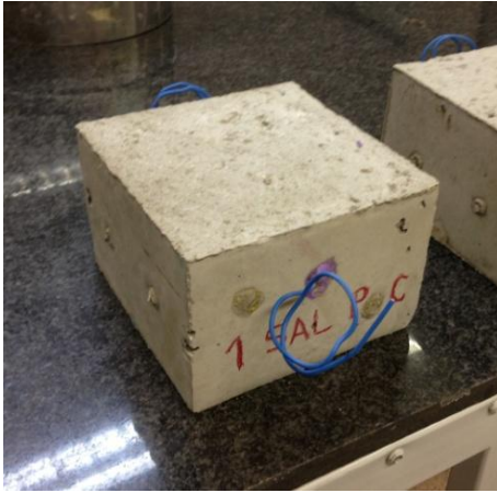
Detalle de probeta prismática desencofrada
