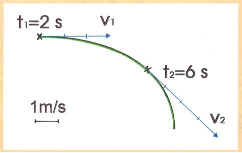
• Intuitivamente pensamos que la variación de velocidad que se ha producido entre el instante  $t_1$ , y el instante  $t_2$  será la diferencia entre la velocidad en el instante final  $\mathbf{v}_2$ , y la velocidad en el instante inicial del intervalo  $\mathbf{v}_1$ . Y lo rápidamente que varía la velocidad vendría indicado por  $\Delta \mathbf{v}/\Delta t$ , que recibe el nombre de vector *aceleración media*. Pero, ¿cómo se halla la diferencia de dos magnitudes vectoriales?, ¿cómo se restan?
