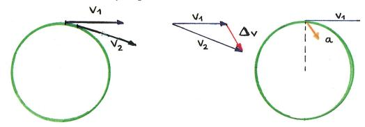
En el intervalo,  $t_2 - t_1$ , considerado muy pequeño,  $\Delta \mathbf{v}$  será el representado en la figura; y la aceleración,  $\Delta \mathbf{v}/\Delta t$ , tendrá la dirección y el sentido, en el punto A, que se indica.
