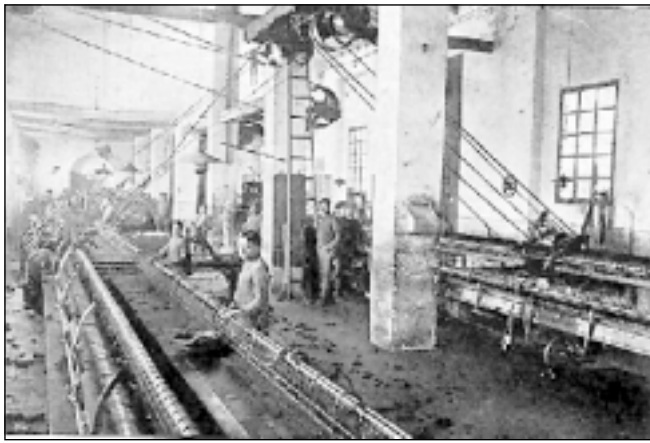
Foto 2. Transmisión de la energía desde la rueda hidráulica o máquina de vapor mediante poleas y ruedas en el interior de una fábrica. FUENTE: Alcoy Artístico Industrial.
