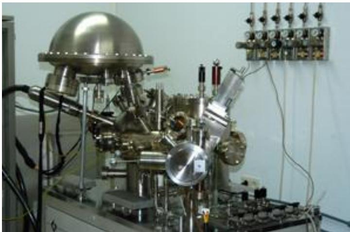
Figura 2. 20. Equipo de espectroscopia fotoelectrónica de rayos-X(XPS).
