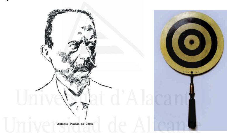
Figura 11 - Retrato de Antonio Plácido da Costa (1848 -1916) junto al instrumento que desarrolló para valorar la curvatura corneal conocido como disco de Plácido.
