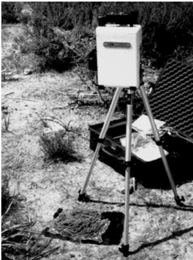
Fig. 1. Imagen del espectro-radiómetro utilizado en las mediciones de laboratorio
