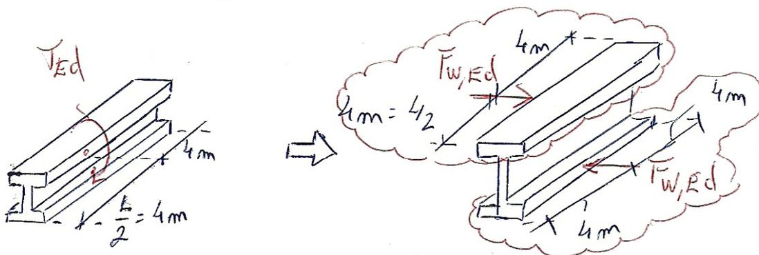
A partir de ahora, el ala superior e inferior son dos piezas prismáticas biempotradas (porque la bama original era biempotrada) sometidas a una carga puntual  $F_{w,Ed}$  en su punto medio. Ahora, calcularemos las tensiones que genera esa carga puntual en la sección [y esas serán las tensiones generadas por el toron que estábamos buscando]
