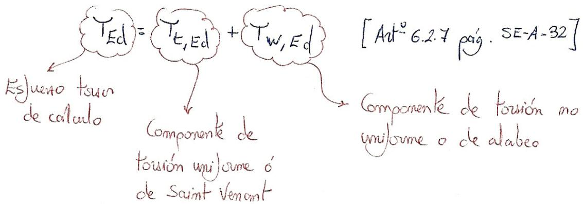
Sin embargo, en el Artº 6.2.7 pto. 3 del CTE DB SE-A, se indica que en las piezas formadas por un perfil en doble T (IPE, HEB, etc.) puede despreciarse la componente de torsión uniforme ó de Saint Venant. Luego:
