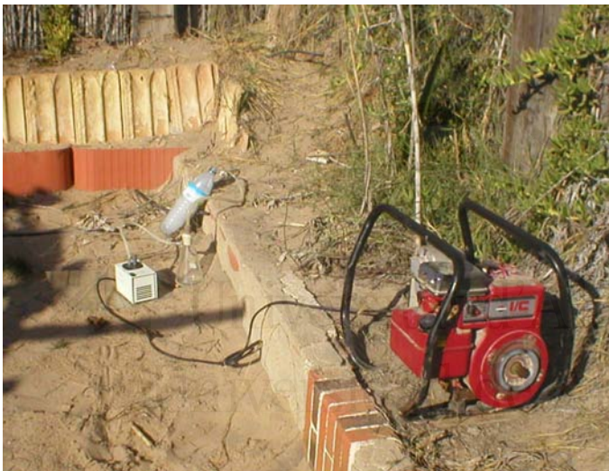
Bomba de succión y grupo electrógeno para producir energía eléctrica, conectados a la espiral con orificios, 2003.
