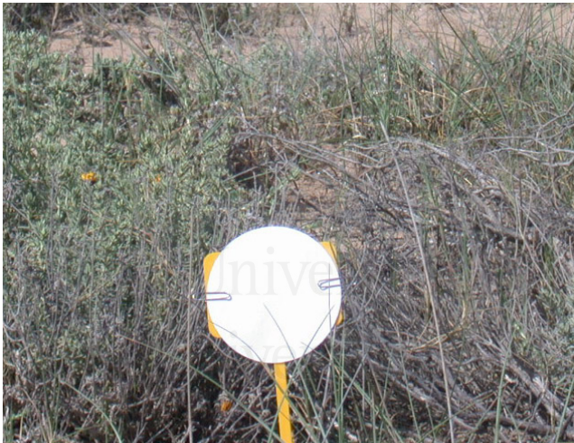
Captadores de papel de filtrado utilizados en las tomas de muestras del spray marino.
