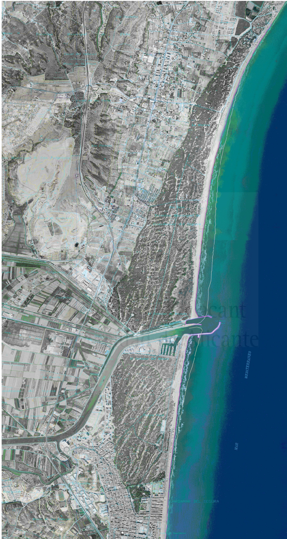
Plano de restitución litoral en la bahía del río Segura. En las playas situadas al norte y sur del río Segura, la reconstrucción de las dos líneas de costa más separadas en el tiempo de las que disponemos fotografía aérea, el vuelo de Ruiz de Alda (1929-30) y de 2004, colocadas de manera superpuesta, permite conocer la evolución general de la línea litoral en un periodo de casi 75 años. Se pone en evidencia la desaparición de un estrecho delta existente en el año 1929 hasta la situación actual más lineal de la línea litoral. El retroceso de las playas más acusado se produce al norte, con unos 175 m, y va siendo menor hasta llegar a los 3.750 m de distancia al río, frente a La Marina. Hacia el sur el retroceso alcanza unos 3.000 m, con un ancho máximo de unos 150 m, en que ya aparece una situación de aparente estabilidad en el frente litoral, comparado ambas líneas de costa. En color claro está dibujada la línea de 1929 y en violeta la de 2.004.
