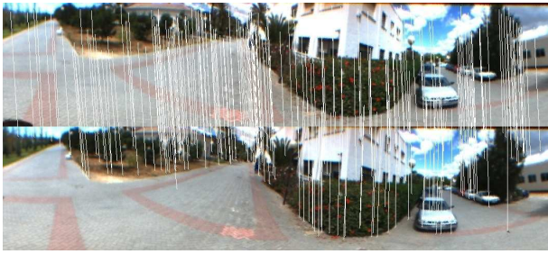
Fig. 11. Imagen 2 (arriba) emparejada con la 1 (abajo) utilizando el algoritmo GTM y los descriptores SIFT.
