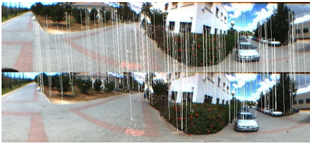
Fig. 12. Emparejamiento de la imagen 2 (arriba) con la 1 (abajo) mediante el uso del descriptor SURF y el algoritmo GTM.
