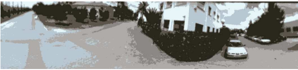
Fig. 4. K-Means con k = 6 aplicado a la imagen 1.
