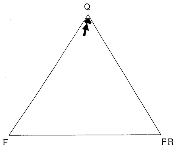
Figura 4.- Posición de las areniscas (cuarcarenitas) en el diagrama de Folk (1974).
