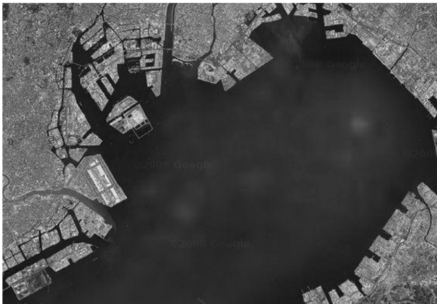
Figura 3. Terrenos ganados al mar en Tokio, mediante utilización de gomi . Fuente: Google Earth.
