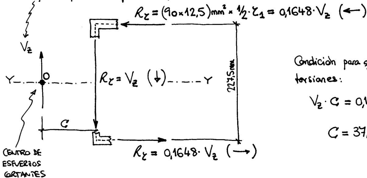
Distancia de O hasta la cara exterior del perfil:  $C = \frac{t_w}{2} = 33,99 \approx 34 \text{ mm}$
