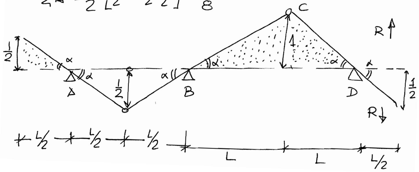
c) Para obtener la distribución p sima de la carga distribuida, considerando la carga puntual en el tramo AB, hay que valorar la m xima reacci n ocasionada.
