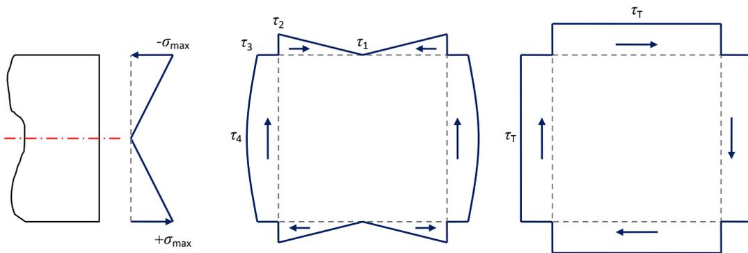
La máxima tensión tangencial se produce a mitad de altura de la pared lateral izquierda del tubo y vale  $(3,283 + 30,78) \cdot P = 34,06 \cdot P$  MPa. Pero en esa posición la tensión normal es 0. La tensión equivalente de Von Mises será:
