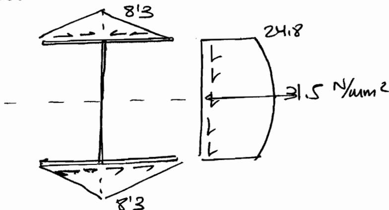
(b) Con el fin de obtener el máximo torsor  $T$  que resiste la sección, debe obtenerse previamente el margen de tensiones tangenciales del que dispone esta hasta su agotamiento. Por ello, aplicamos el criterio de Von Mises:
