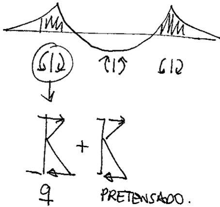
→ COMO POSIBLE SOLUCIÓN PODRÍAMOS DISEÑAR UN PRETENSADO CON DIRECTRIZ VARIABLE, QUE COMPRIMIERA LA PARTE INFERIOR EN EL CENTRO DE LA VIGA Y LA ZONA SUPERIOR DE LA SECCIÓN EN LAS ZONAS LATERALES. NO OBSTANTE, ESE DISEÑO QUEDA FUERA DE LO OBJETIVO DE LA ASIGNATURA.
