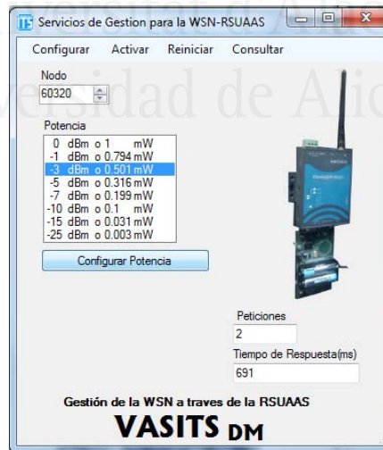
Figura 85. Gestión para el sistema de monitorización empleado (WSN), configurando la potencia del nodo 442 a través de SOA
