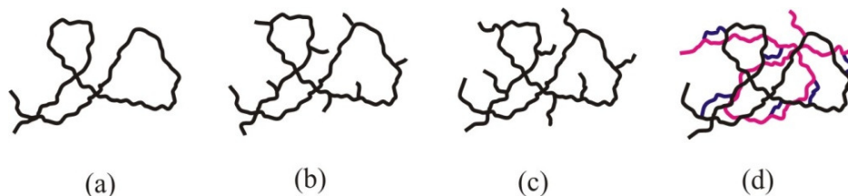
Figura 1.5. Polímero lineal sin ramificaciones (a), con ramificaciones cortas (b), con ramificaciones largas (c) y polímero entrecruzado (d).
