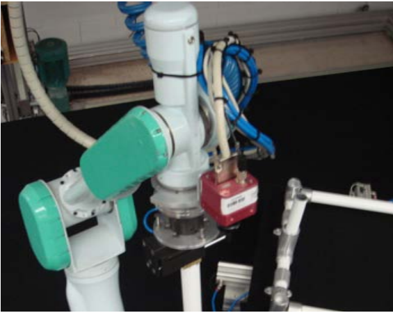
Fig. 7-5 Configuración "eye-in-hand" en el Robot 1
