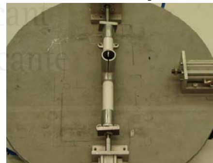
Fig. 7-8 Estructura de aluminio base para la tarea de inserción
