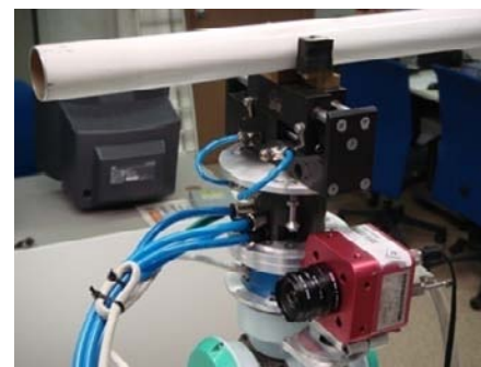
Fig. 7-10 Configuración del extremo del robot con la pieza a insertar
