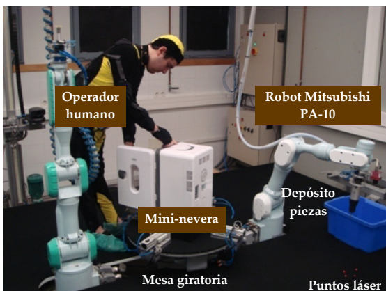
Fig. 7-35 Arquitectura del sistema para la tarea de desensamblado de la mini-nevera
