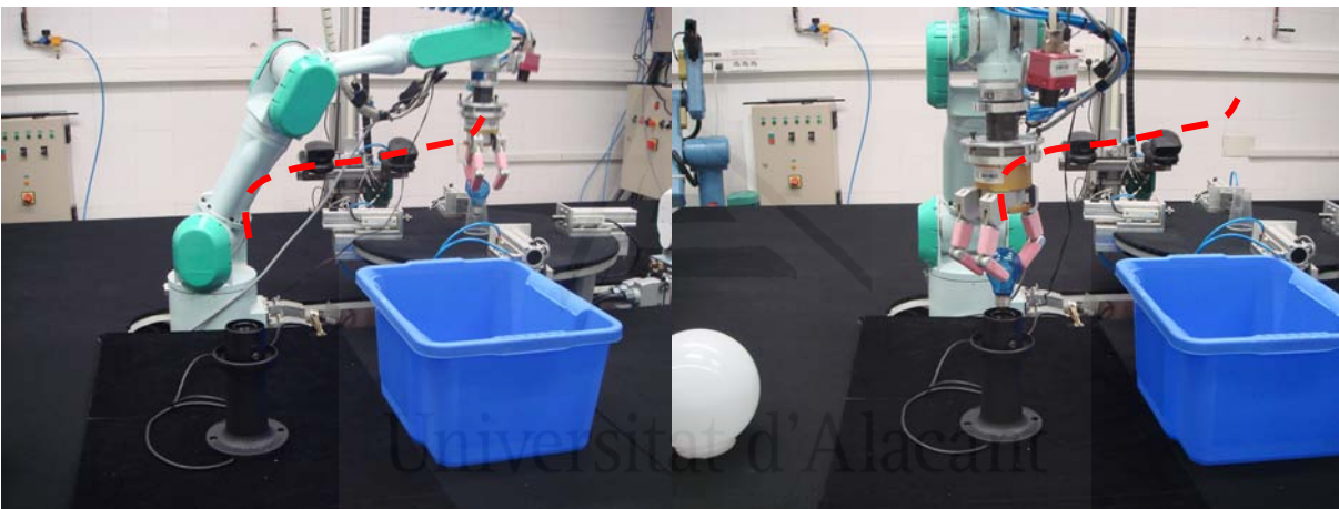
Fig. 7-23 Trayectoria para poner la bombilla nueva en la lámpara
