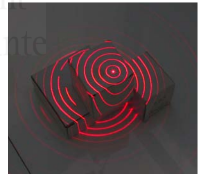
Fig. 6-13 Proyección de láser sobre una superficie escalonada
