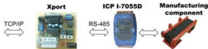
Fig. 31. Escenario del WS Gateway para la maquinaria industrial.
