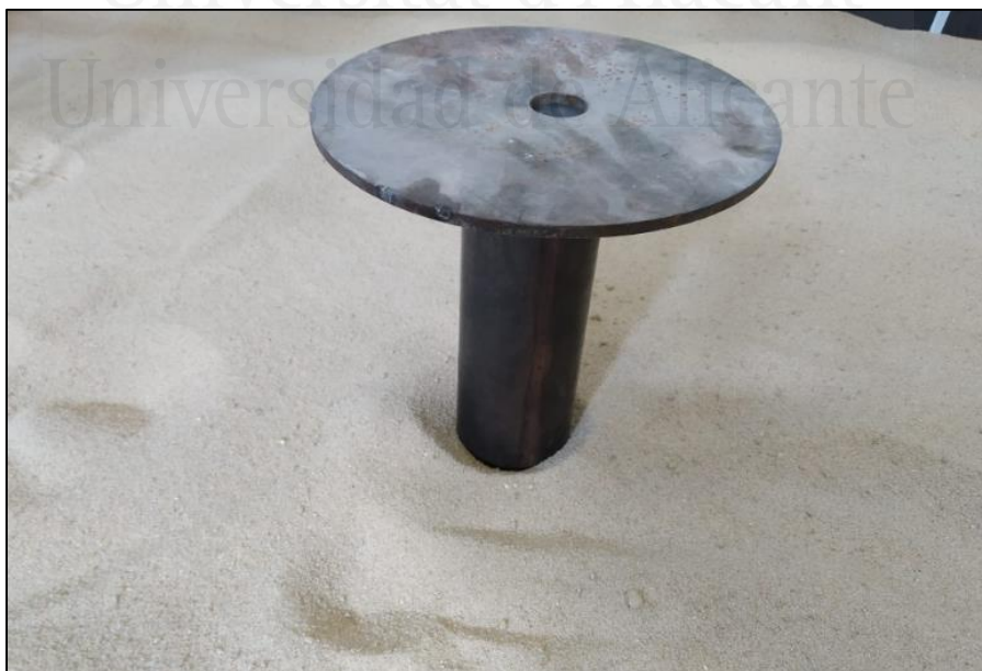
Figura 20. Platabanda circular metálica para una mejor distribución de la carga aplicada.
