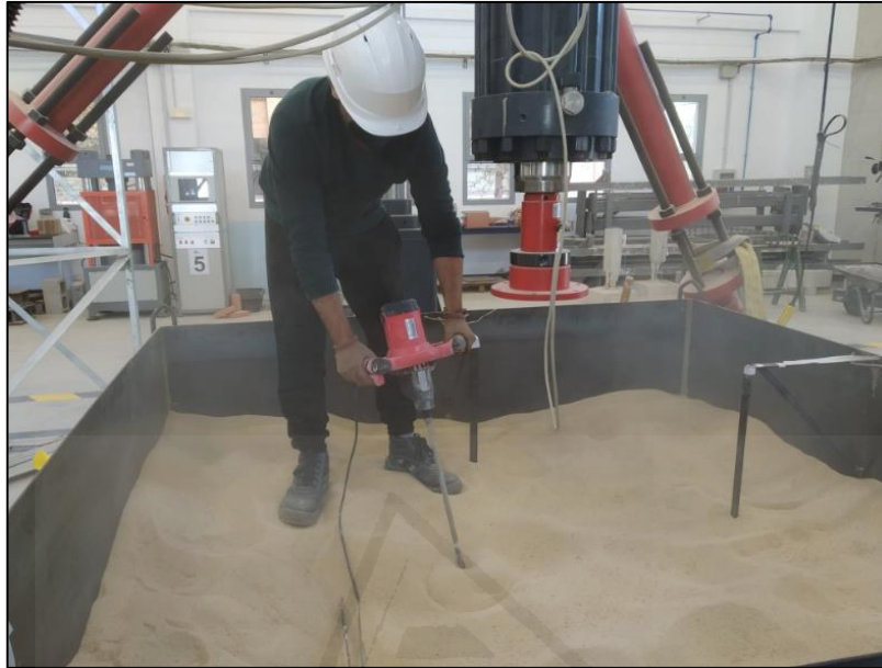
Figura 21. Descompactando la arena mediante un vibrador.
