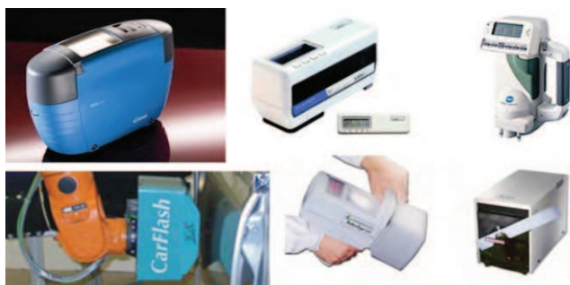
Figura 8. Exemplos de espectrofotômetros multiângulos existentes no mercado durante a última década. De cima para baixo e da esquerda para a direita: BykMac, X-Rite MA68II, Konica Minolta CM-512m3, Optronik CarFlash, GretagMacbeth ColorEye640 e GretagMacbeth ColorEye-6.
