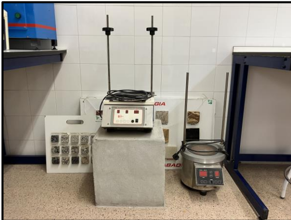
Figura 6.3. Máquina de tamizado
