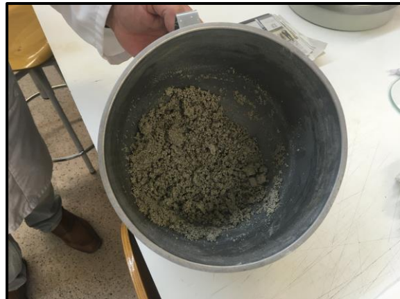
Figura 0.2. Amasado de mortero de Cal de Marrakech
