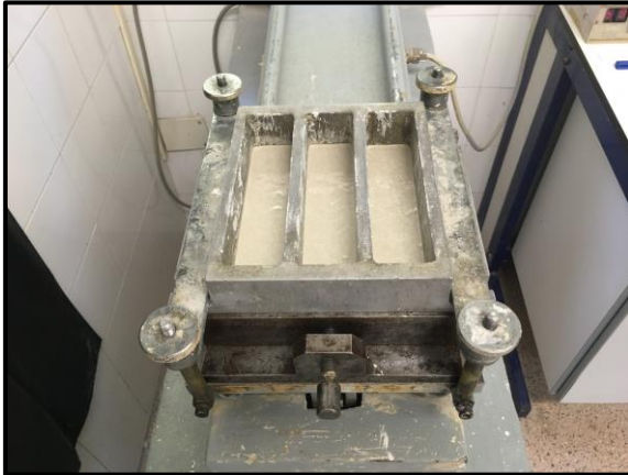
Figura 0.5. Molde de acero en la compactadora
