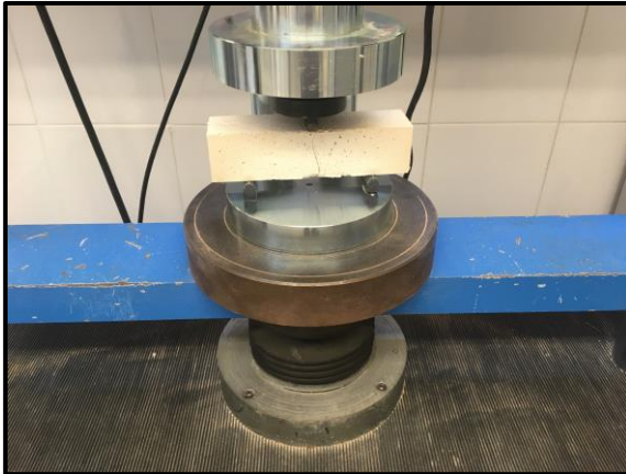
Figura 7.1. Ensayo de resistencia a flexión
