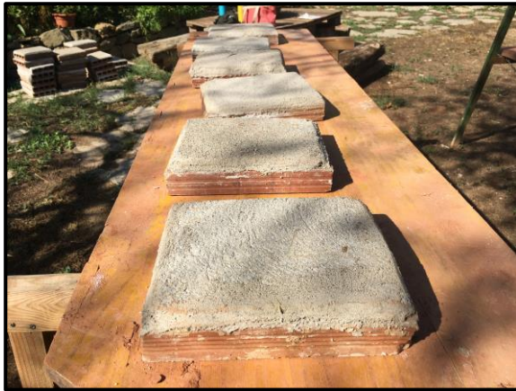
Figura 10.3. Soportes cerámicos con capa base de mortero NHL
