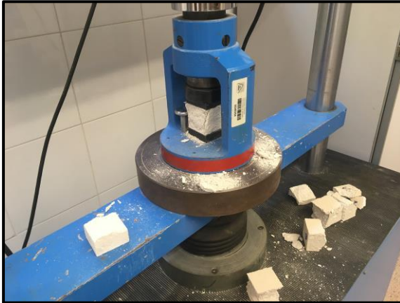
Figura 7.3. Ensayo de resistencia a compresión
