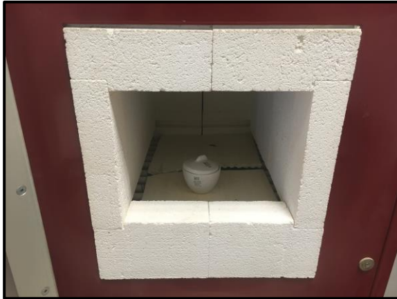
Figura 5.3. Crisol con tapa en horno de mufla
