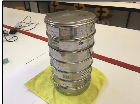
Figura 6.4. Columna de tamizado
