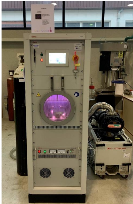
Figura 3. Equipo de plasma de baja presión disponible en INESCOP.
