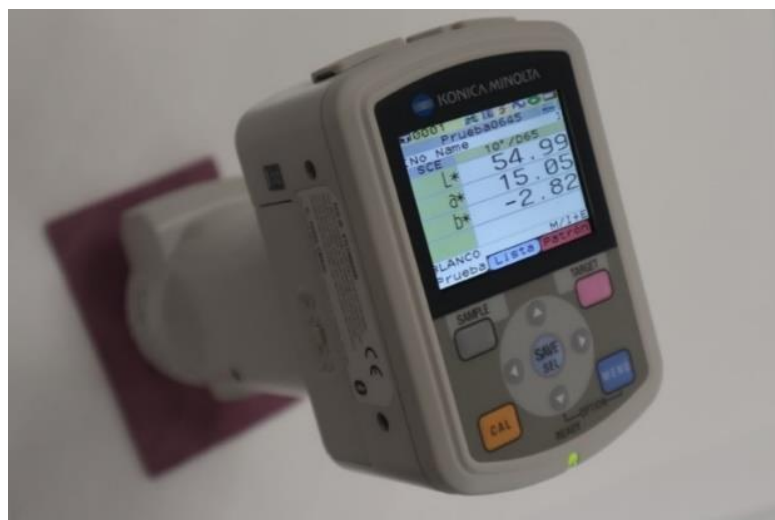
Figura 20. Colorímetro empleado para obtener los valores triestímulo L^*a^*b^* .
