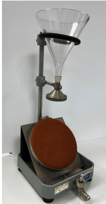
Figura 22. Equipo utilizado para realizar el ensayo de rociado.
