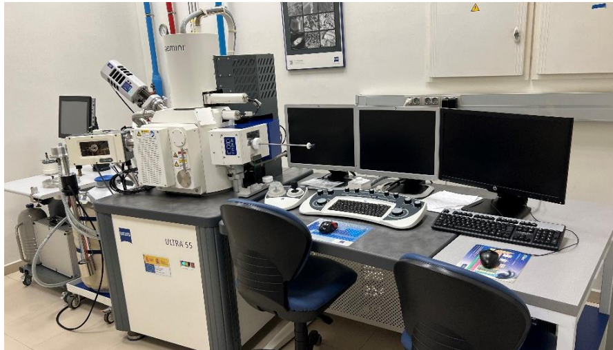
Figura 16. Equipo empleado para el análisis SEM.
