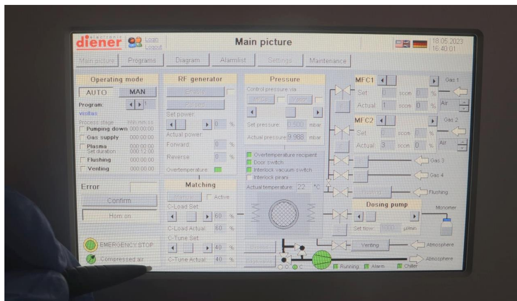
Figura 8. Monitor de control del equipo de plasma de baja presión.
