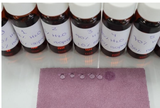
Figura 34. Realización del ensayo de repelencia al agua sobre la muestra M2
