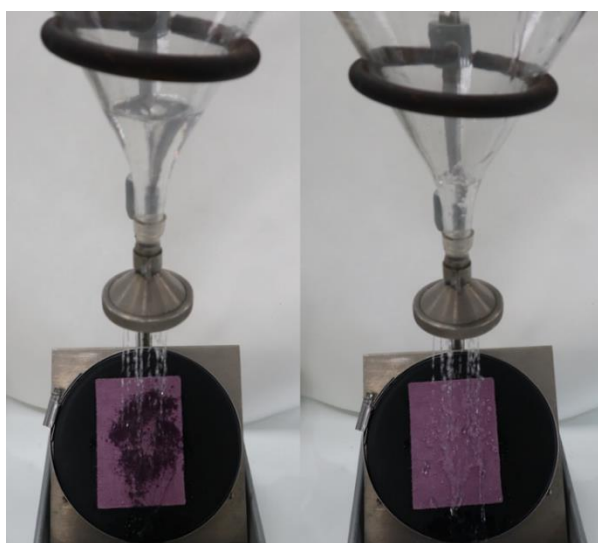
Figura 37. Ensayo de rociado sobre la muestra control sin tratamiento (izquierda) y la muestra tratada con una potencia de aplicación de plasma de baja presión del 30% (derecha).
