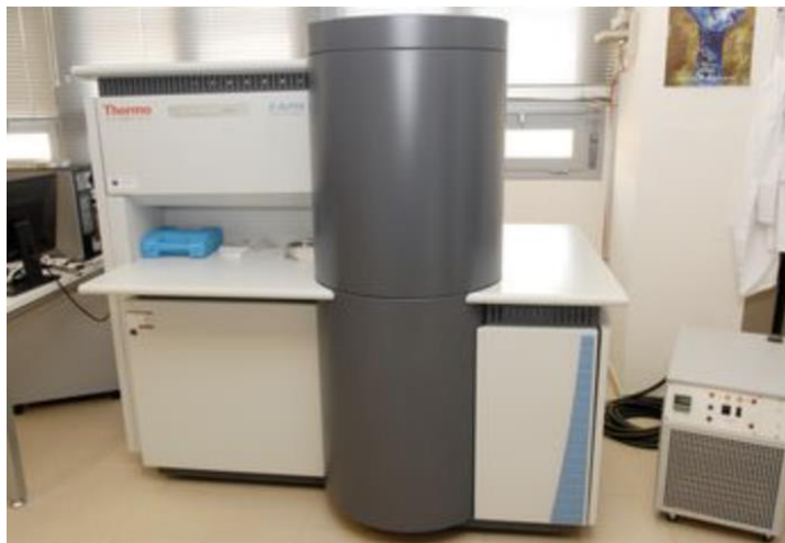
Figura 15. Equipo empleado para el análisis XPS.
