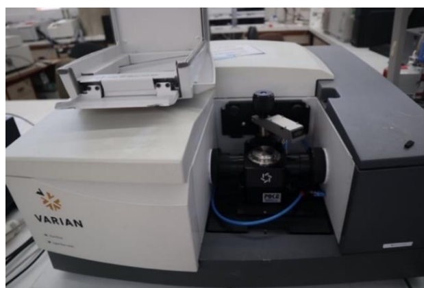
Figura 14. Espectrómetro utilizado para obtener el espectro infrarrojo de las muestras.
