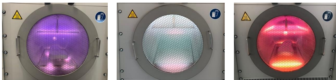
Figura 2. Luz emitida por el plasma de argón (izquierda), helio (centro) y nitrógeno (derecha).
