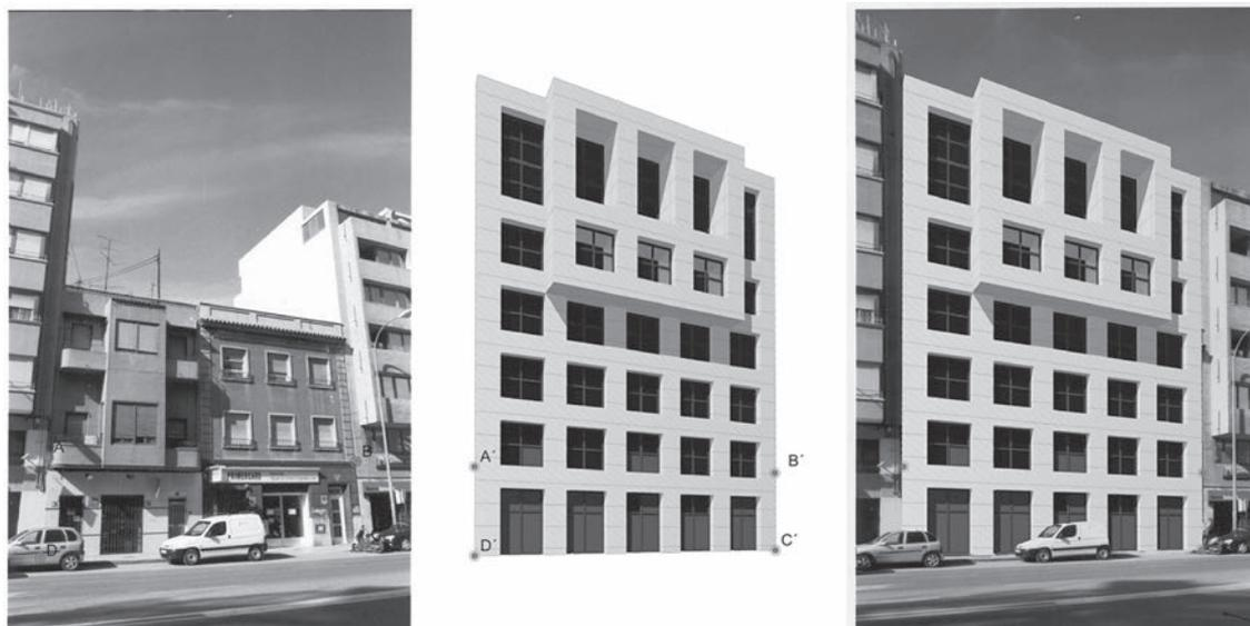
Figura 06. Transformación homográfica de la instantánea del entorno “estirando” homográficamente la imagen del entorno hasta que los puntos A, B, C y D coincidan con sus homólogos A', B', C', D'.
