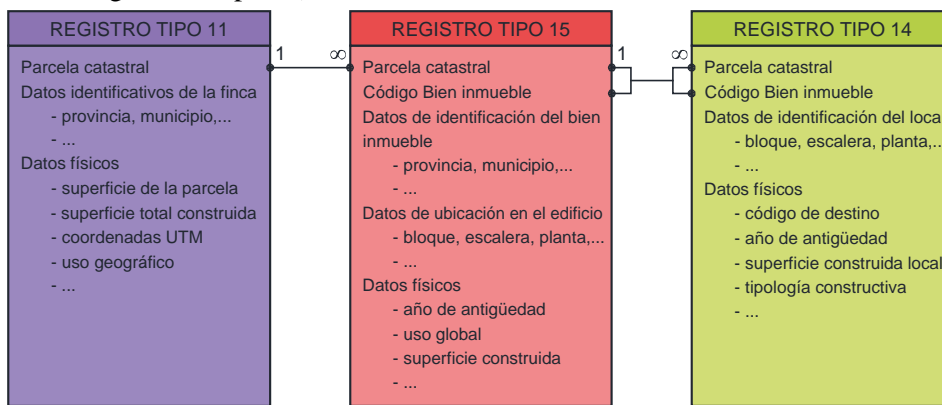
Figura 5. Esquema de las relaciones entre los registros de datos alfanuméricos. Fuente: elaboración propia.
