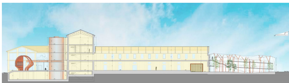
Figura 4. Sección longitudinal. De izquierda a derecha en Planta Baja: Escultura-Hito, Núcleo de Comunicaciones, Sala de Exposiciones Temporales, Sala de Exposiciones Arqueología, Sala del Tesoro, Geoda e Intercambiador de épocas-Sala de Exposiciones. Fuente: elaboración propia.
