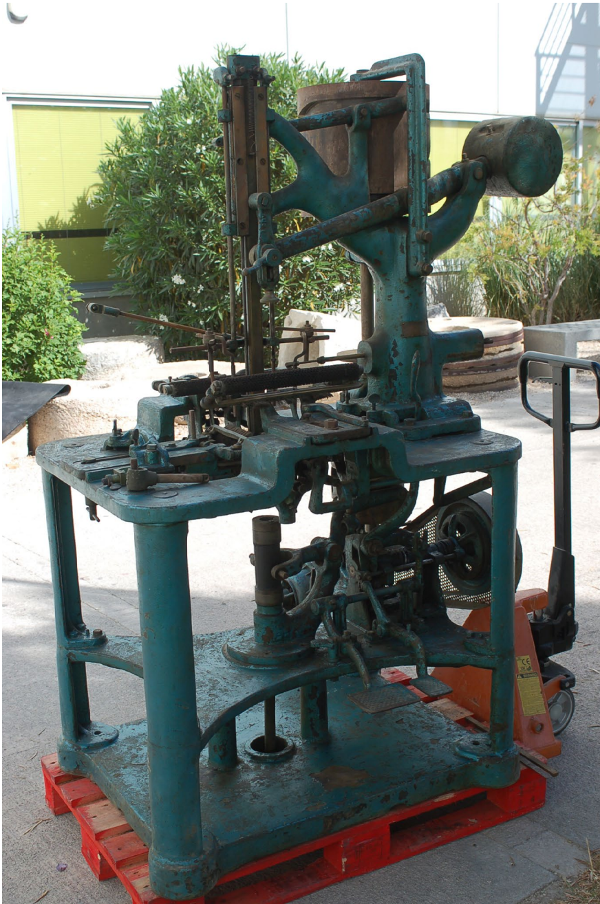
Figura 8. Máquina de forrar cajas de cartón conservada en el Museo del Calzado de Elda. Fotografía: Museo del Calzado de Elda.
