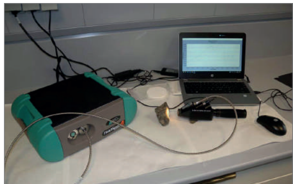
Figura 4.9. El espectralradiómetro es el aparato de referencia en la metodología de Espectroscopia de Reflectancia de Fibra Óptica
