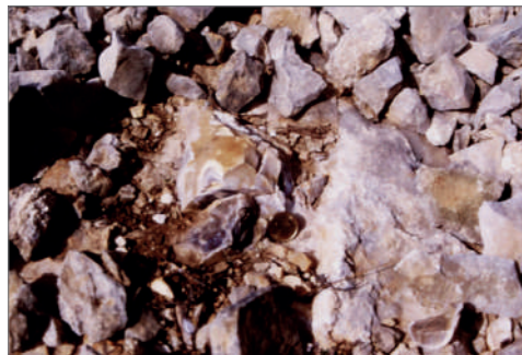
Figura 6.73. Detalle de un nódulo de sílex de gran calidad en su matriz caliza
