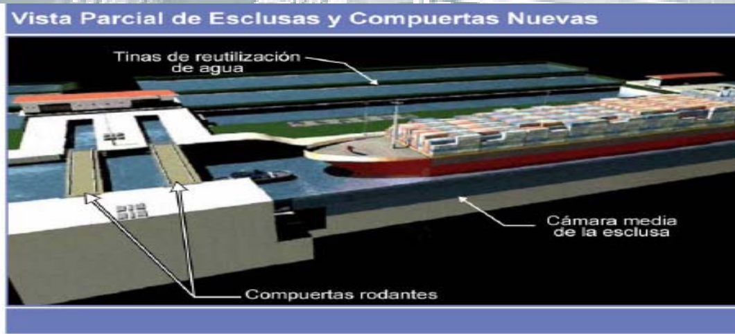
Figura 31 Las esclusas utilizarán compuertas rodantes. Utilizarán remolcadores para maniobrar y asistir a los buques durante el proceso de esclusaje.
