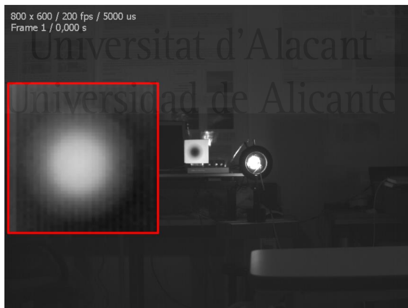
Figura 2.3. Imagen de la diana utilizada para determinar la precisión experimental de los métodos subpíxel. En el recuadro rojo se muestra una ampliación de la diana en negativo (Mas et al., 2016b).
