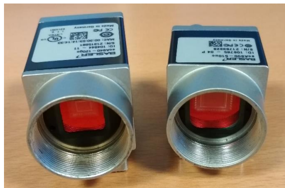
Figura AII.1. Cámaras BASLER mostradas por la parte delantera por donde se puede observar la diferencia en el tamaño del sensor.
