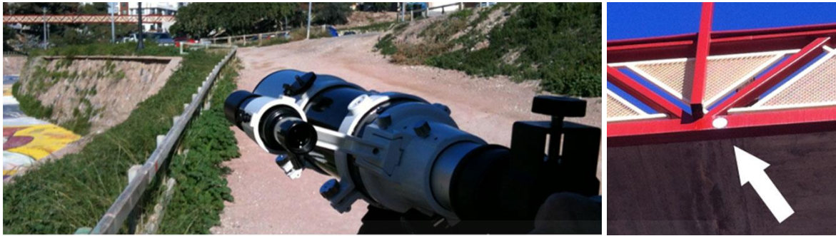
Figura 2.4. Grabación experimental de una diana circular sobre un puente para medir su vibración (Ferrer et al., 2016). A la derecha se muestra la diana ampliada.
