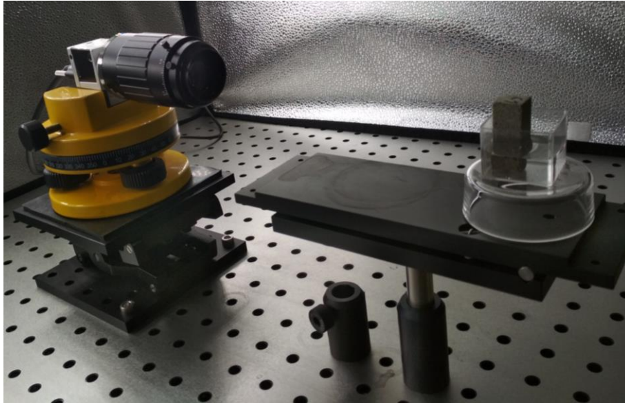
Figura 4.3. Montaje experimental para realizar las medidas de la expansión de las rocas areniscas en el laboratorio.
