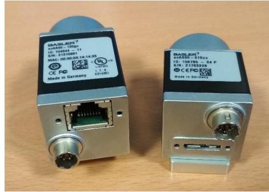
Figura AII.2. Cámaras BASLER con conexión Gigabit Ethernet (izquierda) y USB 3.0 (derecha) para la transferencia de datos al ordenador.
