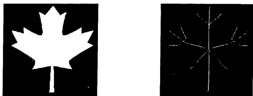
Figura 4: Región binaria y el resultado de aplicar el algoritmo de esqueletización.
