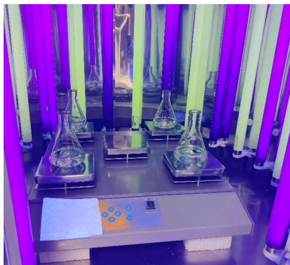
Figura 11: Imagen del interior del fotoreactor en funcionamiento.
