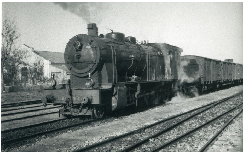
Figura 1. Locomotora de vapor 240 - 2133 de RENFE, ex. nº 1153 de la Compañía MZA, fabricada por Henschel en el año 1913 con nº de fábrica 12120, en la estación de Villena. Signatura: FF- 3274- Fuente: Archivo Histórico Ferroviario del Museo del Ferrocarril de Madrid-Fundación de los Ferrocarriles Españoles (Colección: Gustavo Reder Klingebell) .
