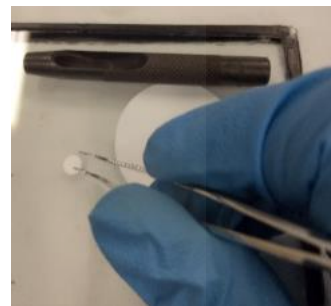
(c) nylon separator membrane.
