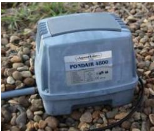
Fig. 36. Compresor de 60 W de acuario
