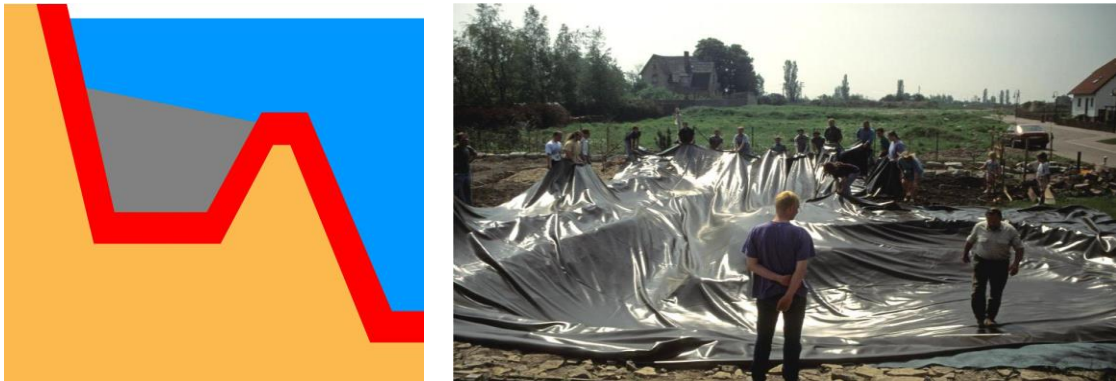
Fig. 41. Sección separación zona regeneración sin partición
